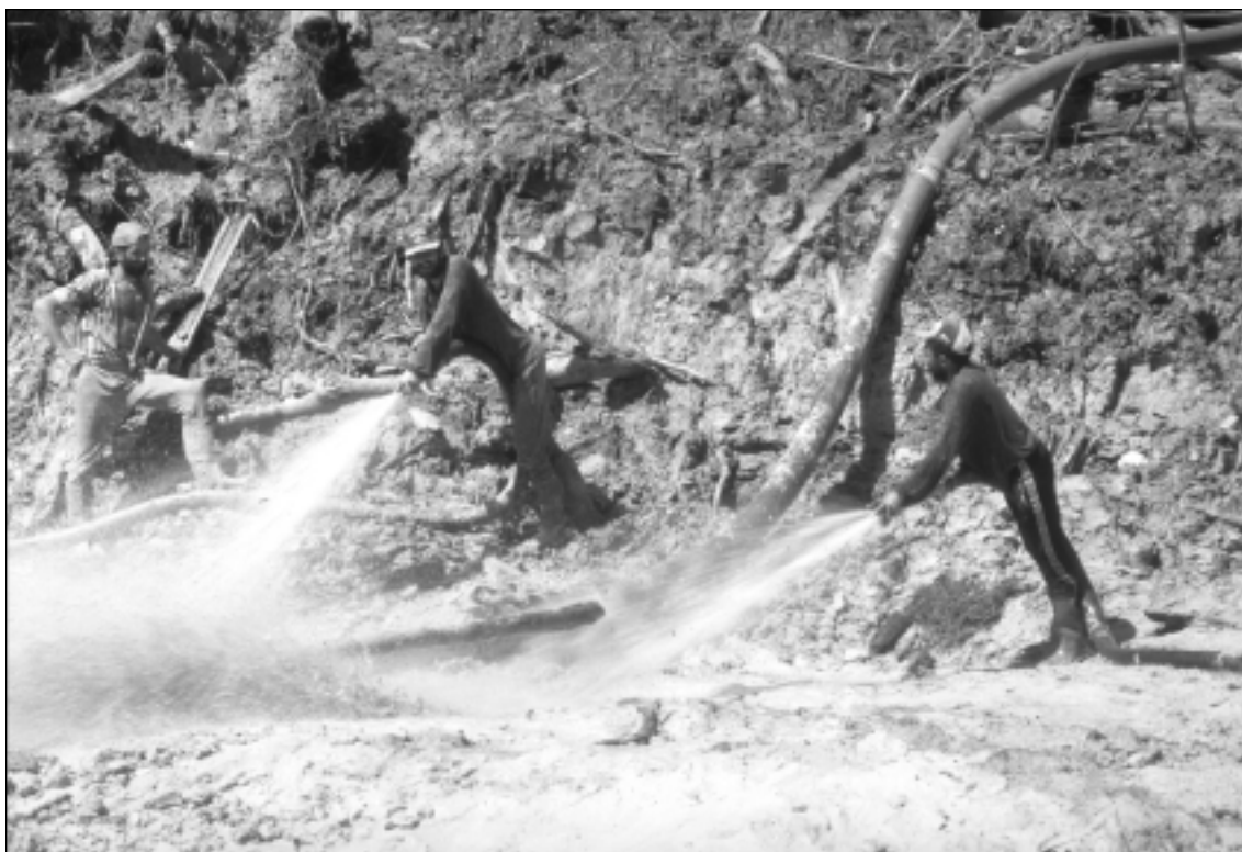
photo 42 : Exploitation de l'or éluvionnaire. Les lances monitors permettent la liquéfaction des argiles dans lesquelles l'or est piégé. Sur ce chantier, les pompes fonctionnent en continu 24 heures sur 24. Nous voyons ici la relève d'une des équipes (Dorlin, Petit-Inini, Guyane Française). (cliché J. F. Orru, 1998)
