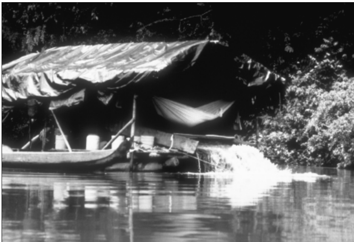
photo 41 : Drague pour l'exploitation de l'or sur les cours d'eau. Son fonctionnement est simple : en amont, un plongeur oriente, du fond de la rivière, un tuyau d'aspiration relié sur le ponton à une pompe qui déverse les alluvions sur une table inclinée où l'or est retenu par des moquettes (haut Maroni, Guyane Française). (cliché J. F. Orru, 1997)
