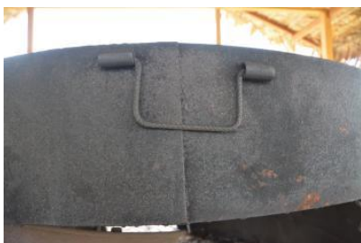
Photo 9: Soudure pour la transformation de platine à cassave en platine à couac
