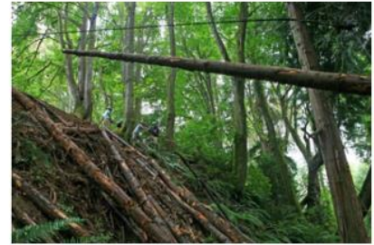
Transport du bois par câbles - Adapté aux pentes fortes
