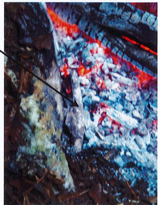
Ecaille de quartz détachée de la paroi par le feu
