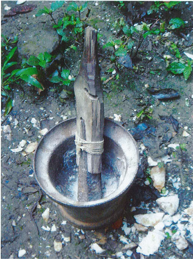
Fig. 6 : Mortier en acier pour le broyage du quartz aurifère et pilon (actuel).
