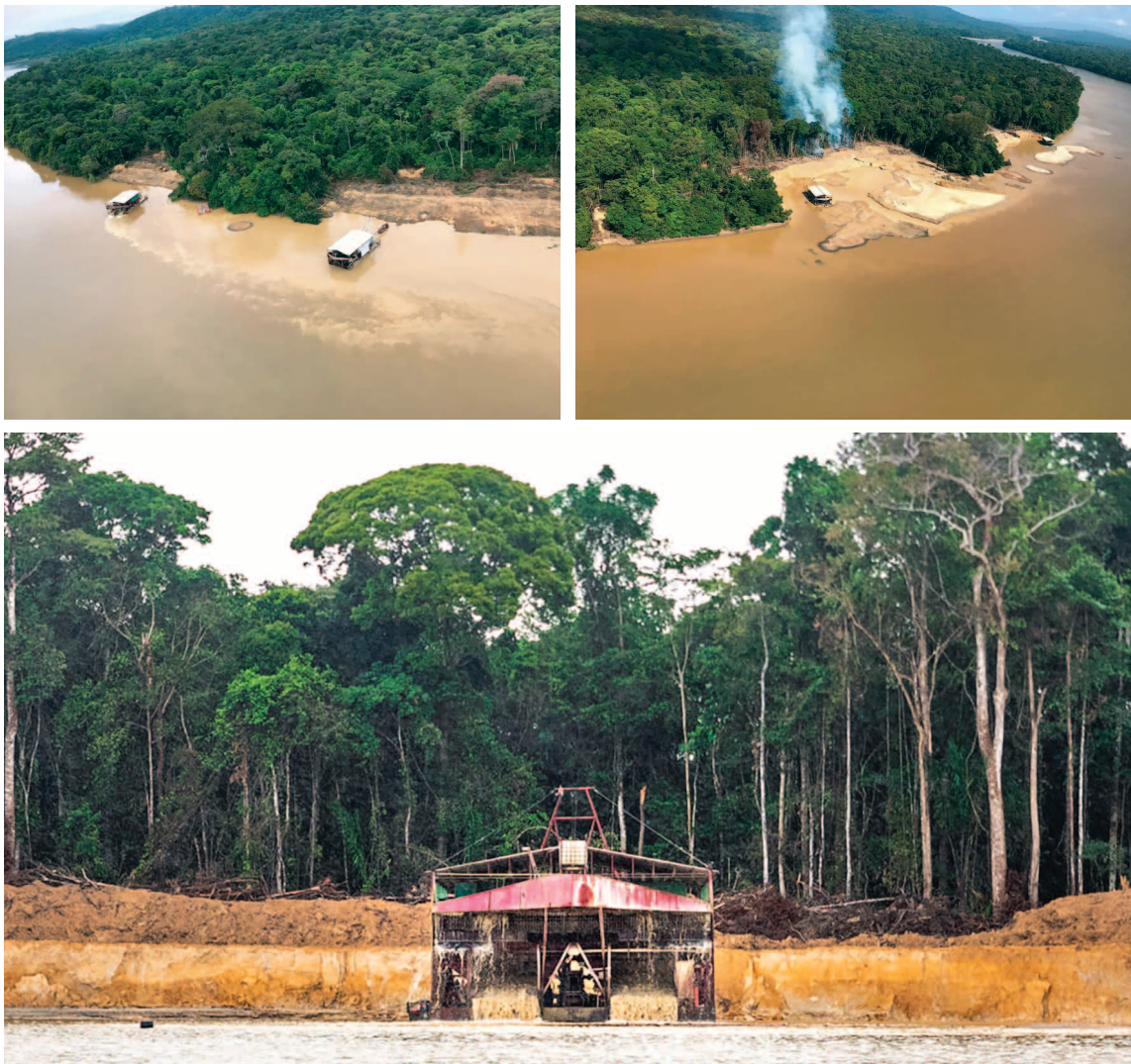
Exemples de barges de dragage œuvrant en 2019 sur la rive surinamaïse du Maroni.
