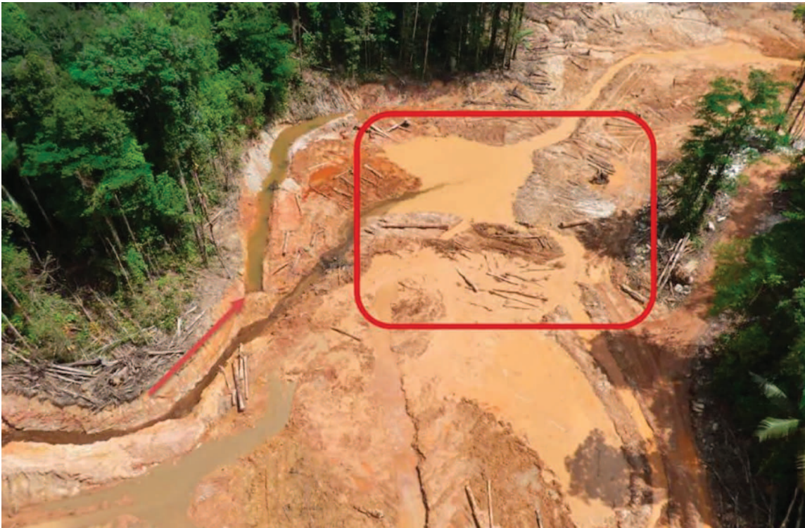
Barranque mal comblée en fin d'exploitation fournissant une très importante charge en MES polluant le linéaire aval de la crique.
