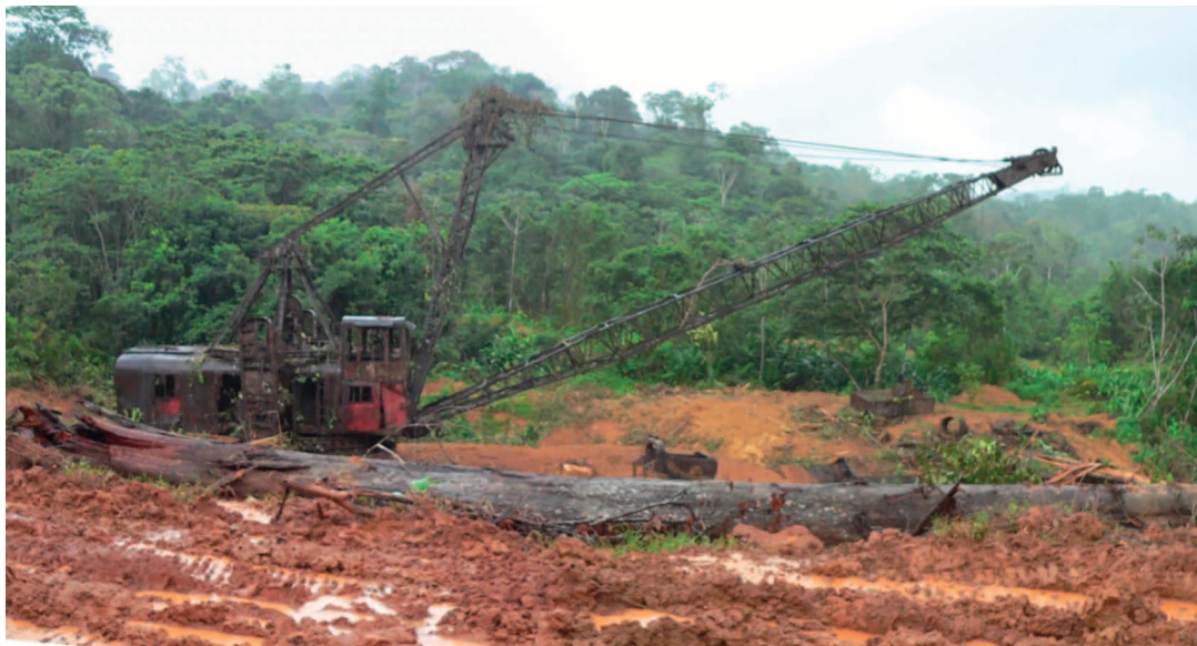
Dragline Page (modèle 618) possédant un godet de près de 4 m 3 . Elle fut mise en service sur la crique Boulanger en 1956 puis abandonnée dès 1960 dans un contexte de cessation de l'activité (in Laperche et al., 2008).
