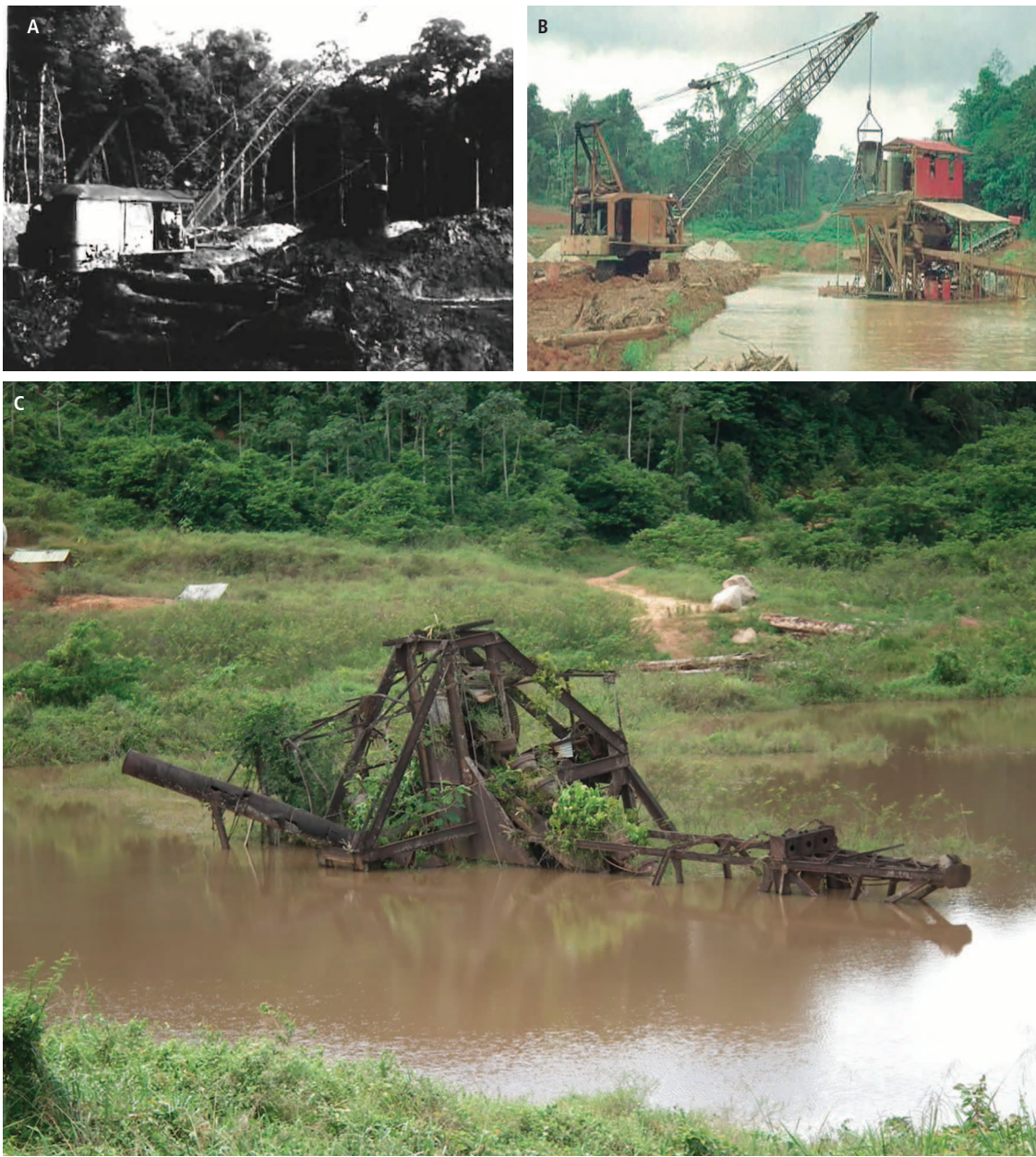
Draglines du gisement Paul Isnard : (A) en service sur l'exploitation alluvionnaire de la crique Petit Léopard au début des années 1970 (in Blancaneaux, 1974). (B) En service sur le placer Élysée (en 1984) (in Matheus, 2019). (C) Aujourd'hui abandonnée sur le placer Élysée.
