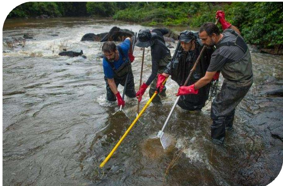
Figure 93 : Les experts d'HYDRECO utilisent la méthode de la pêche électrique en basse conductivité.
