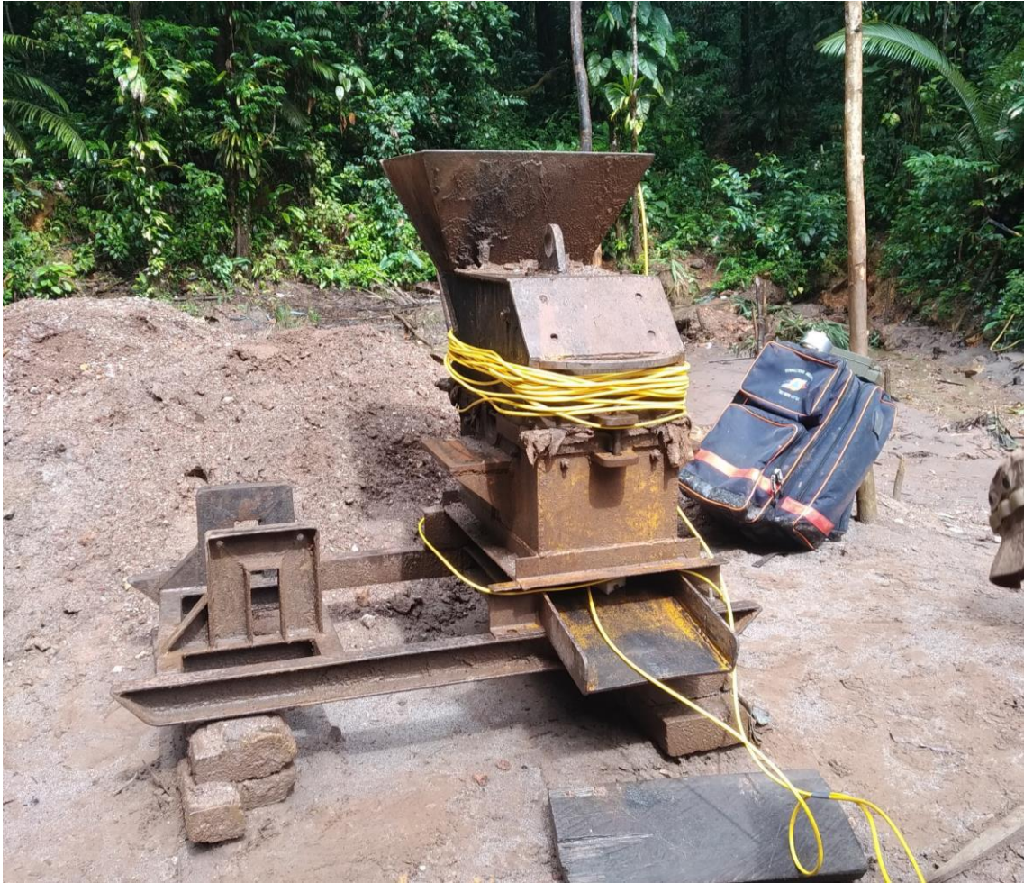
Concasseur prêt à être détruit au C4.
