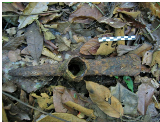
Pic d'orpailleur pour les alluvions (à gauche) et pour le travail du quartz après abattage au feu ; Saül.
