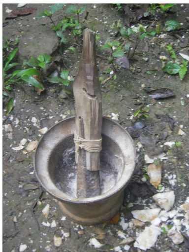
« Pilon » de broyage du quartz, avec son « manche-pilon », Saül ; ci-dessous : le manche-pilon de M. Samuel Richard.
