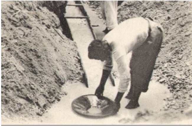
Lavage à la battée en sortie de sluice ; détail d'une carte postale ancienne.
