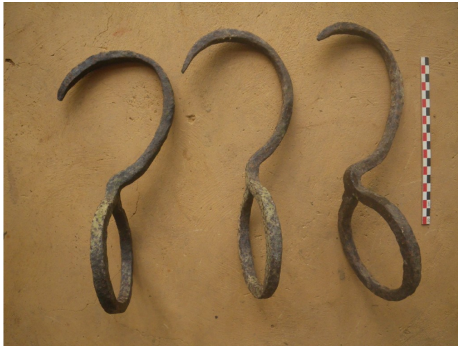
Crochets-dalle à anneau fermé de la maison Agasso ; noter l'amincissement du métal au point bas.
